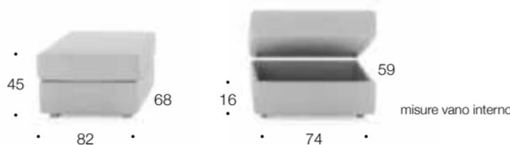
La struttura è realizzata in legno, rivestita con vellutino accoppiato. La seduta è in poliuretano espanso densità 25 kg/mc. Il pouf Fly può essere richiesto con le ruote in tinta argento o con il piede in legno colore bronzo vintage. Il cuscino di seduta si solleva facilmente tramite un meccanismo a molla, scoprendo un capiente vano interno da 59x74 H 16 cm. Fly è rivestibile in tessuto, similpelle e pelle ed è completamente sfoderabile.
